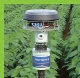
農場に各種のセンサを配置して無線 LAN で結び、農場の状態を常時監視。
